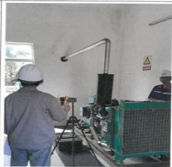
2025.10.14 发电机房氨氧化物检测
